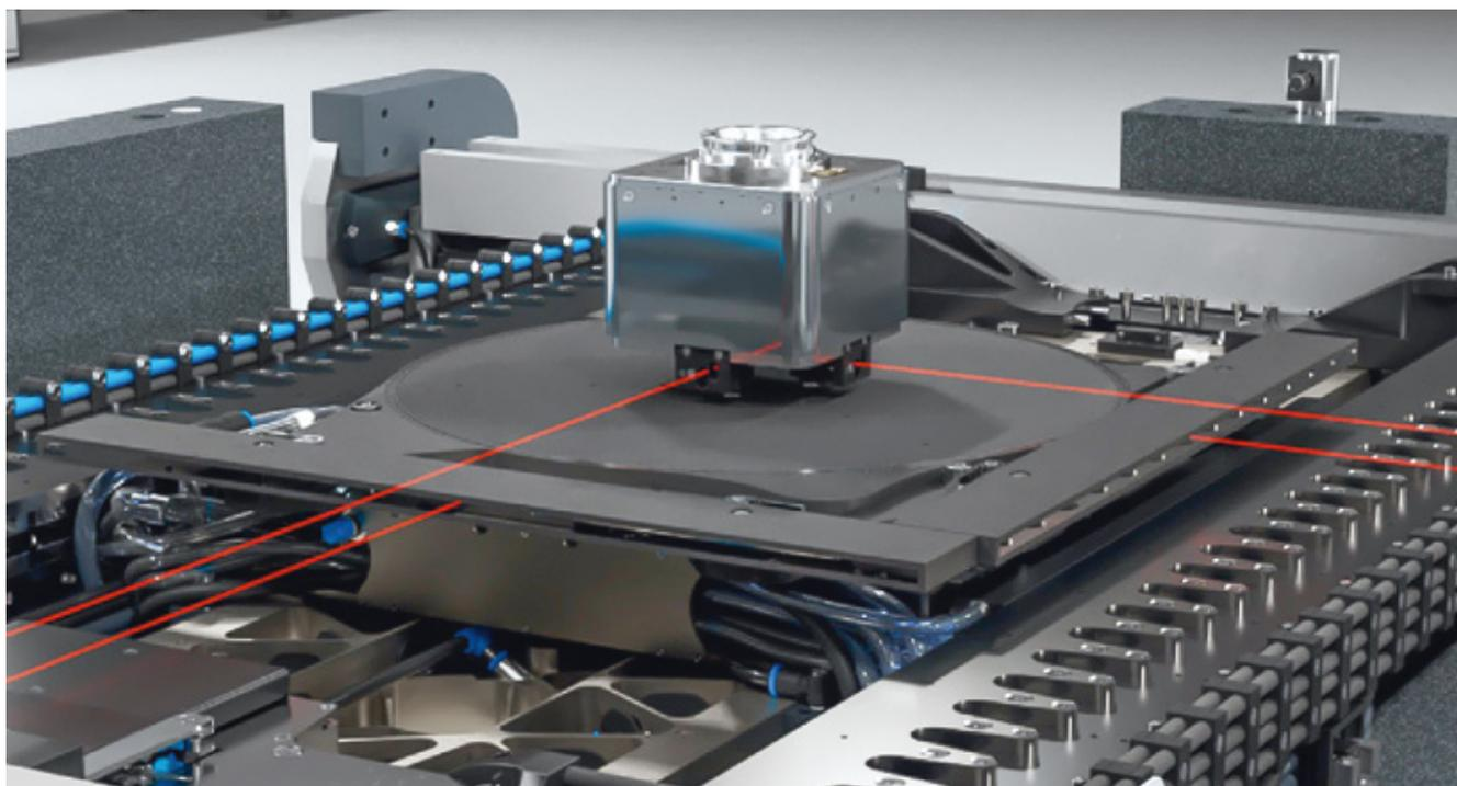
Bild 5. Differenzinterferometer in der Dynamic Waferstage
