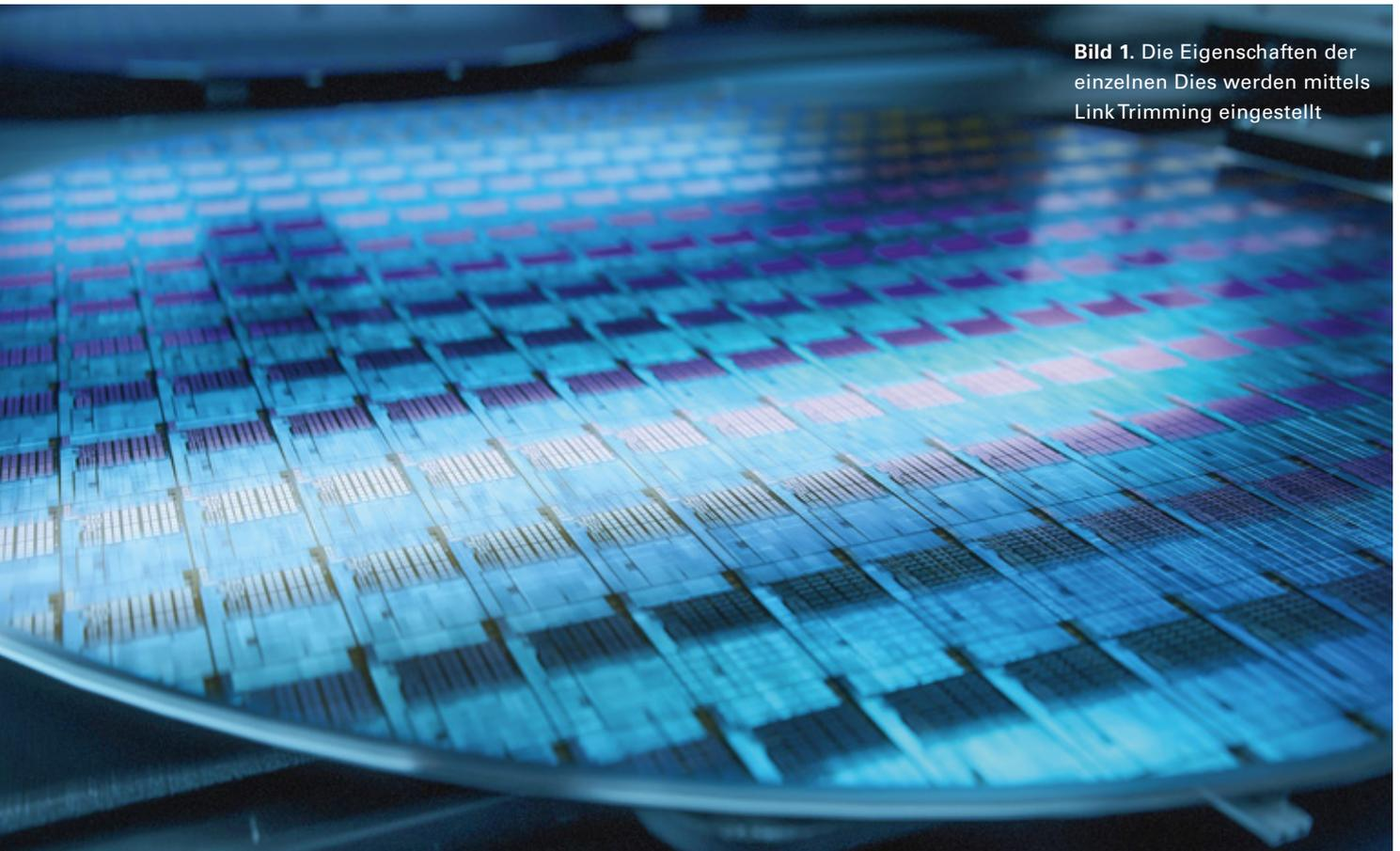
**Bild 1.** Die Eigenschaften der einzelnen Dies werden mittels Link Trimming eingestellt
